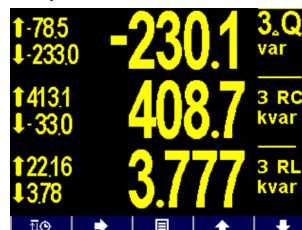
Obr. 4.21 : Kompenzační rezervy - kapacitní rezerva nedostatečná
