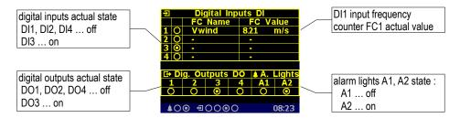
The digital I/O actual data screen shows actual state of all of the inputs and outputs :
